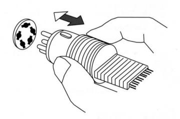
When unplugging, be sure to hold the plug, not the cord. 注意 コードの抜き着しは必すプラグを持って行ってください。
