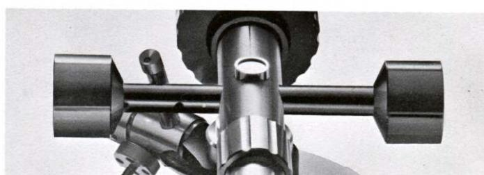
●カートリッジの“ゆくらぎ”を防止するアンチロールスタビライザー ●パイプ交換部にチャッキングコネクターを採用 ●アンチロールスタビライザーは同時に支点部周辺の質量を増すことにより共振を抑えます。
