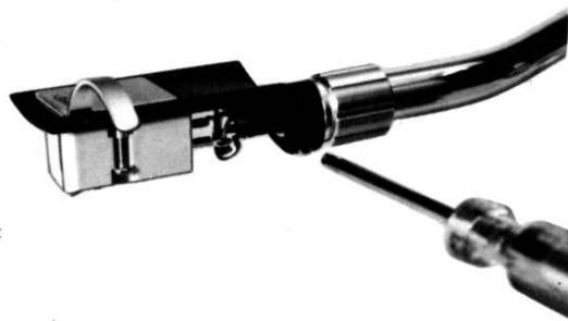
UA-7/70規格 ■形式 バイブ交換式マルチ・ユース・インテグレーテッド型 ■適合カートリッジ マグネットイック型およびコンデンサー型 ■軸受 特殊2点支持方式（高感度宝石軸受およびボールベアリング外輪によるスタビライザー） ■バランス方式 スタティック・バランス ■シェル U字型無共振構造 針先位置可変(8mm) ■リフト オイル制動方式 ■出力コード ノイズレス低容量 長さ120cm ■高さ調整範囲（プレーヤー・ボードとシェル・カートリッジ取付面の間）45~78mm
