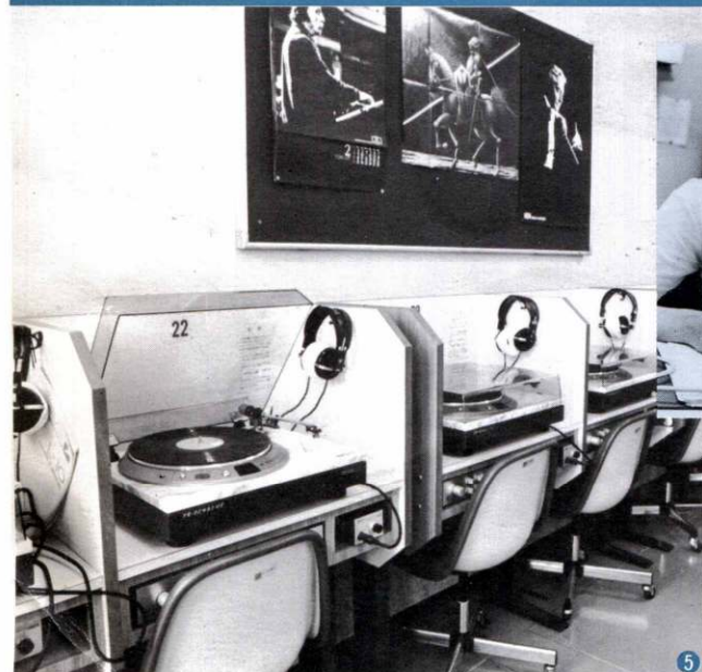
写真⑤: 明治大学・図書館 / レコードプレーヤーとプリメインアンプの組合せにアダプターとイヤースピーカーを加えたシステム。 写真⑥: ニューヨーク・Hunter College / グレードアップのために、従来のダイナミック型ヘッドホンをコンデンサー型のイヤースピーカーに換えて使用している。
