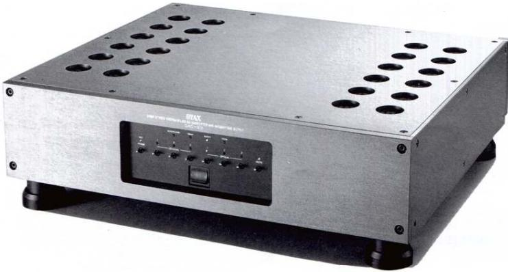
●スタックスがディジタル技術で初めて世に問うた製品が、CDP QUATTROでした。4倍オーバーサンプリングのディジタルフィルターを用い、世界で初めてアナログ・フィルター・レスのダイレクトアウトを装備。世界の注目を集めましたが、その技術に更に磨きをかけて、進化させ、DAコンバーター単体としてまとめたのが、このDAG-X1tです。①真空管を出力段に用い、②DAコンバーターにアメリカ製の20bitハイブリッドICを左右2channel分ずつ使い、③インバーティング・アンプ無しでバランスアウトを実現。④電源部をA：ディジタル部、B：右DA、アナログ部、C：左DA、アナログ部と三つに分け、⑤電源トランス、⑥電源コードまで三つに分けることにより、お互いのノイズの混入、クロストークを根本から洗い直しました。⑦入力には光3系統、⑧コアキシャル3系統を用意、⑨レバー・スイッチ一つで瞬時に切り換えられます。また⑩ディジタル回路内で絶対位相の切り換えを行うためのスイッチも装備。⑪評判の8倍オーバー・サンプリングのディジタル・フィルターを探
