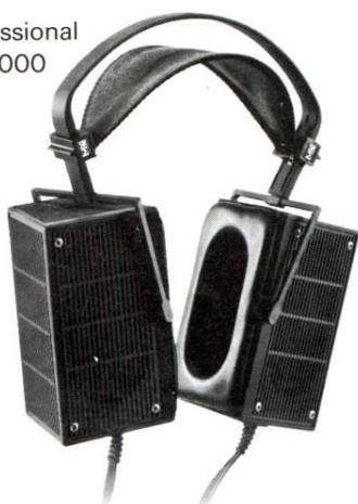
●4年の歳月を費やして開発に成功したSR-Σは大きい小判型ユニットを耳の前方に配置する独特の構造により、それまでのヘッドフォンでは望んでも実現できなかった音場の拡がり感と音楽の持つ透明な空気感、自然な臨場感を見事に再現してくれました。そのSR-Σをさらに発展、改良し、振動膜に1.5ミクロン、ケーブルにPC-OCC、固定極間のギャップを600ミクロンから1,000ミクロンに拡大した製品がSR-Σ Professionalです。音像が頭の中に集中することも無く、長時間のリスニングも楽に行えるのが大きな特長です。
