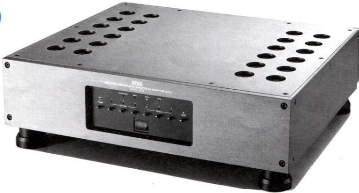
●スタックスがデジタル技術で初めて世に問うた製品が、CDP QUATTROでした。4倍オーバーサンプリングのデジタルフィルターを用い、世界で初めてアナログ・フィルター・レスのダイレクトアウトを装備。世界の注目を集めましたが、その技術に更に磨きをかけて、進化させ、DAコンバーター単体としてまとめたのが、このDAX-X1tです。①真空管を出力段に用い、②DAコンバーターにアメリカ製の20bitハイブリットICを左右2channel分ずつ使い、③インバーティング・アンプ無しでバランスアウトを実現。④電源部をA:デジタル部、B:右DA、アナログ部、C:左DA、アナログ部と3つに分け、⑤電源トランジistor、⑥電源コードまで3つに分けることにより、お互いのノイズの混入、クロストークを根本から洗い直しました。⑦入力には光3系統、⑧コアキシャル3系統を用意、⑨レバー・スイッチ一つで瞬時に切り替えられます。また⑩デジタル回路内で絶対位相の切り替えを行うためのスイッチも装備。⑪評判の8倍オーバーサンプリングのデジタル・フィルターを採用し、⑫アナログ出力回路を簡略化、⑬極めて
