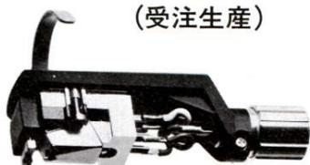
●カートリッジと異なり、アームには固有の音色はないはずなのに、アームによって音が変わってしまう事実は、アームを選ぶ必要性を証明しています。スタックスのマルチユーストーンアーム新UAシリーズは、「適量マス」という概念を導入することによって、どんなカートリッジに対しても最適の実効質量を与えることができるように設計されています。アームの心臓部ともいえる軸受部には、先端が50μRに精密に研磨されたピボットによる1点支持とボールベアリング外輪で左右傾斜を規制するスタビライザーを組合わせた軽量2点支持方式を採用し、初動感度10mgという値を長期にわたって保障します。アームパイプには、カーボンファイバー強化プラスチックという理想的な素材を使用しています。パイプ形状もS字型7cfNとテーパ状に加工されたストレート型(UA-9N/90N)があり、ロングタイプ(UA-90N)も用意されています。その上、パイプはすべて交換式ですから、別売パイプによるバリエーションも楽しめます。
