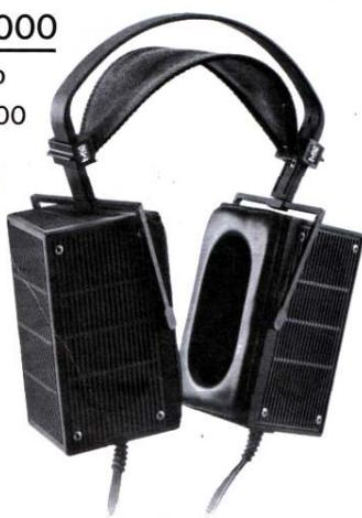
●スタックスが4年の歳月を費やして開発に成功したSR-Σは大型ユニットの採用とユニットを耳の前方に配置する独特的な構造によりこれまでのヘッドフォンでは望み得なかった音場の拡がり感を見事に再現しました。これにより音が頭の芯に集中する事もなく長時間のリスニングが楽に行なえます。更に振動膜を1ミクロン(これまでの1/2)固定極間のギャップを1,000ミクロン(ノーマルは600ミクロン)、ケーブルにPC-OCCを採用したSR-ΣProfessionalが発売されました。
