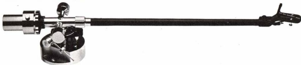
●ワンポイントサポート超高感度トーンアームUAシリーズに新しい仲間、カーボンファイバーパイプのロングアームが加わります。軽量高剛性・共振しにくい素材をさらにテーパー状に加工して、より共振を抑えています。シェル一体化、パイプ内に純銀芯シールド線、チャッキングコネクター、アンチロールスタビライザー、重量級スタンド、NEGLEX 2497出力コードなど大胆かつ細心な改良が随所に施されています。
