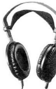
**SR-α Pro** SR-α ProはSR-Λ Proの設計で得られたノウハウをフルに生かし、中高音域の透明度を更に改善したSRシリーズのニュージェネレーションです。円型のダイヤフラムに使われた1.5ミクロンの極薄ポリエチルフィルムは、他のイヤースピーカーシリーズと同様静電気により全面同一位相で駆動され、鳥かご構造によるオープンバック方式ならではののびのびした音を提供します。
