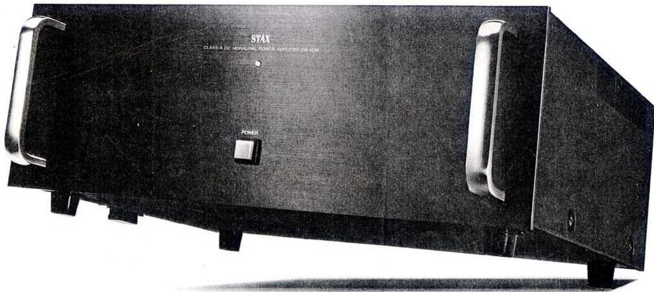
規格 ●実効出力/90W(20~20kHz・8Ω・THD0.1%) ●全高調波歪率/0.04%以下(20Hz~10kHz・90W), 0.004%以下(1kHz) ●ダンピング・ファクター/600(8Ω・1kHz) ●SN比/100dB以上 ●入力感度・入力インピーダンス/1.26V・100kΩ//100pF ●周波数特性/DC~500kHz(DCオペアレート, +0~-3dB・1W出力時), 3Hz~500kHz(ACオペアレート時) ●位相差/+0~3°/DC~10kHz ●寸法・重量/437(W)×166(H)×407(D)mm・20kg
