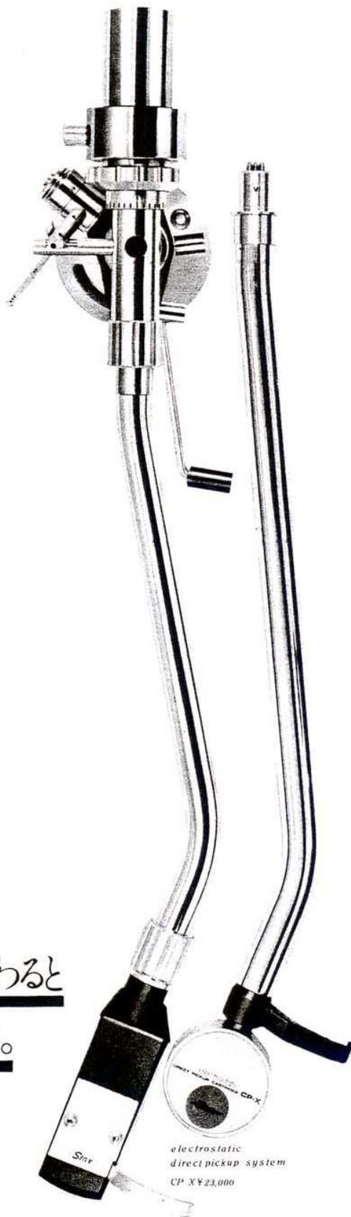
信じられないようだが…本当なのです。第1に、アームの実効質量が大きいと軽針圧での追従性が目立って悪くなり、そりかえったレコードでは針圧を大きくしないとトレースできなくなります。そうなるとうハイコンプライアンスカートリッジもなにもありません。第2に、感度が悪いと、レコードの偏心の影響を受けたり縦方向変調の信号再生が悪化します。スタックスのトーンアームUA-7/70では、剛性の大きな軽合金を巧みに加工して実効質量を大幅に軽減。低域共振周波数 $f_0$ も7-12Hzという理想的な値をとり、さらに精密2点支持サポートで感度わずか5mg未満。上下方向には2個のダンパーがシリーズダンピング効果を発揮、 $f_0$ のピークをおさえるとともに0.1gでも安定したトレースが可能です。あなたのアームをUA-7/70に変えると音が変わるかも知れません。でも、その変わった音がカートリッジ本来の再生音なのです。
